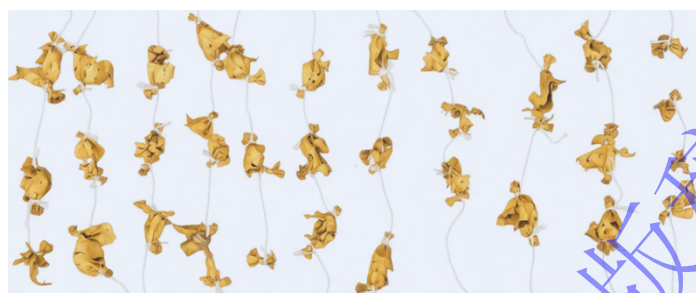
图 13 空心球在水锤效应载荷下的破坏情况
