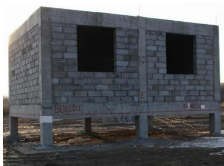
图 11 多房间冲击波传播试验照片 [12]
