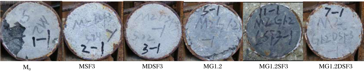
图 2 第 1 次侵彻后不同靶体破坏形态
