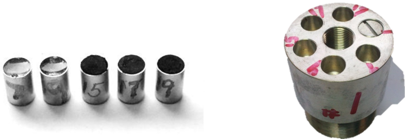
图 1 火炮过载实验样品与工装
