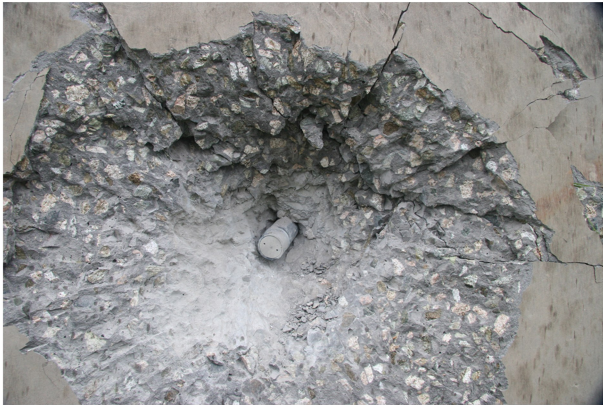
图 2 火炮混凝土过载实验侵彻图片及记录曲线
