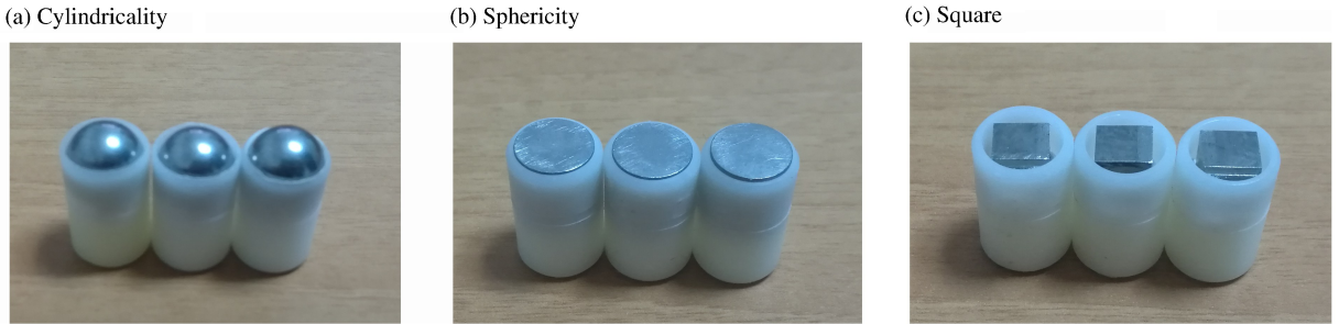
图 5 3 种形状预制破片模拟弹头
