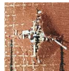
图 5 背面裂缝型损伤形态(实验 6)
