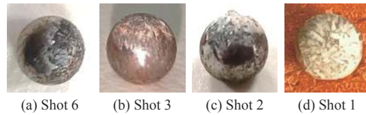
图 3 弹道冲击实验后弹丸回收样品
